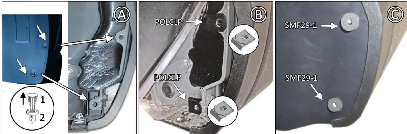
**FIGURE D/E** Posez le garde-boue avec logo orienté vers l'arrière du véhicule sur les points de fixation correspondants de la doublure. Positionnez le support BMF78-RT PAR-DESSUS le garde-boue. Utilisez une rondelle SMWASH et une vis 1SS pour les fixations 1 et 2; un boulon HXBLT avec rondelle SMWASH et un écrou BLKNUT avec rondelle SMWASH à l'ARRIÈRE du garde-boue pour la fixation #3.
