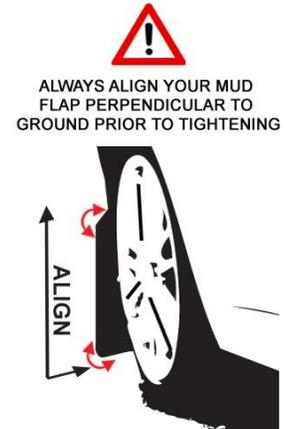
**ALWAYS ALIGN YOUR MUD FLAP PERPENDICULAR TO GROUND PRIOR TO TIGHTENING**
